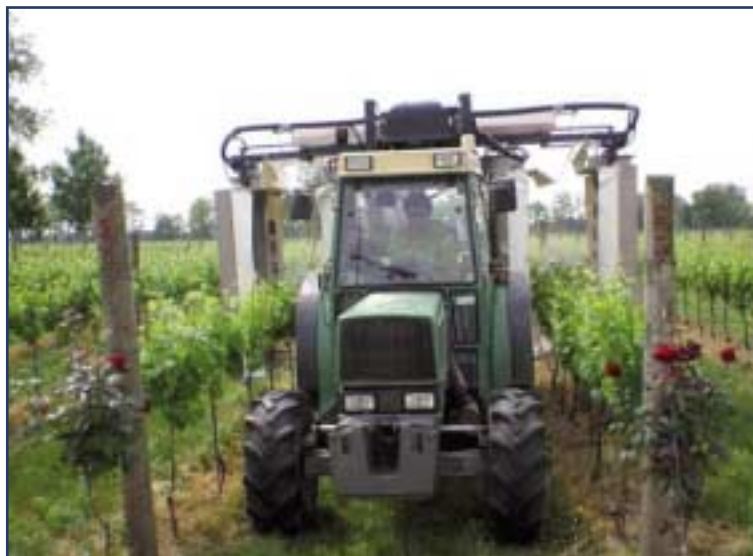
Fig. 1 – Il prototipo di irroratrice a tunnel in lavoro.
