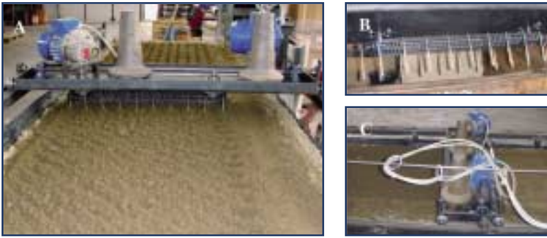
Fig. 1 – 1A modello di “ERPICO” in scala 1/5 con motori elettrici per muovere la catena e traslare il sistema; 1B catenaria con i denti dell’erpicator; 1C vista laterale del carrello.
