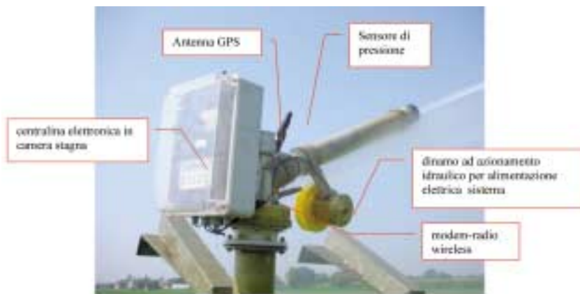
Fig. 2 – Dettaglio del getto e del sistema di controllo (Foto: Bisaglia).
