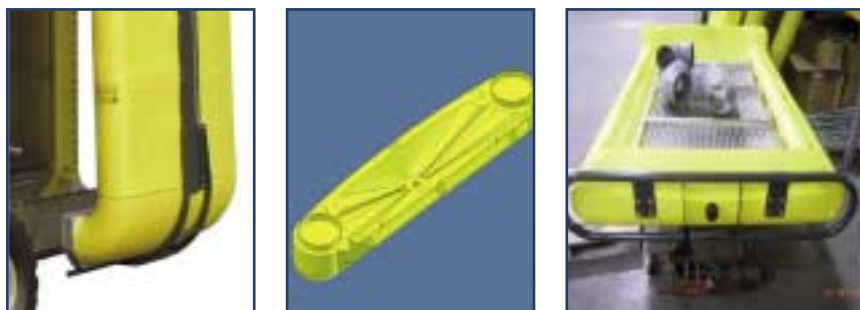
Fig. 6 – 6A vecchio catino montato nella parte inferiore degli scudi del prototipo; 6B schema costruttivo dell’ultima versione del catino; 6C nuovo catino dal basso.
