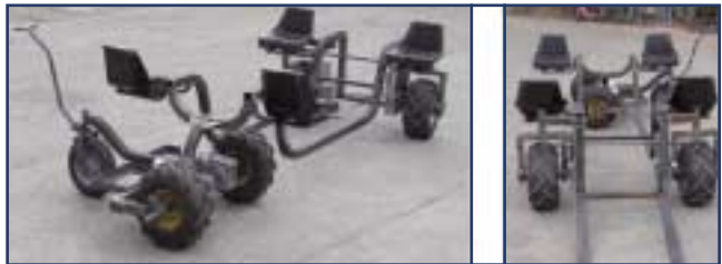
Fig. 4 – Telaio a 4 postazioni, carrello anteriore sterzante a 3 ruote e ponte posteriore sterzante, munito di fork lift.
