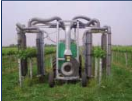
Fig. 3 – Prototipo modificato nelle prove con i pannelli in vetroresina.
