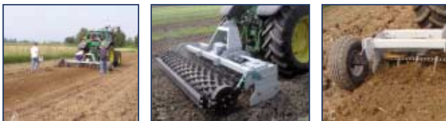
Fig. 4 – 4A prototipo durante le prime prove operative di campo; 4B macchina equipaggiata con rullo frangizolle; 4C particolare della catena torta dai denti che sollevano le punte.
