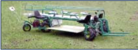
Fig. 5 – Prototipo di macchina agevolatrice per la raccolta e per il confezionamento dell’uva da tavola: vista laterale.
