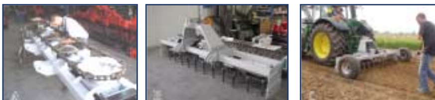
Fig. 3 – 3A telaio rovesciato per il montaggio della catena; 3B primo prototipo completato; 3C prototipo allestito per la sperimentazione operativa in campo.
