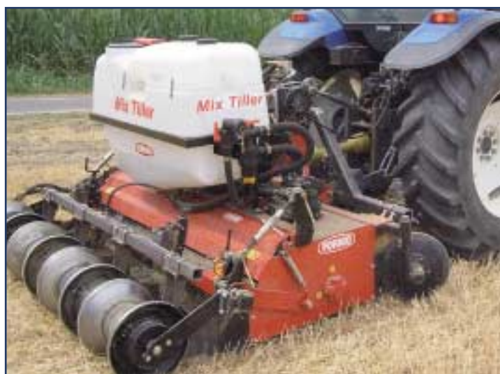
Figura 1 – Mix Tiller nella versione definitiva per la distribuzione sottosuperficiale di prodotti chimici o biologici ad azione diserbante o curativa.
