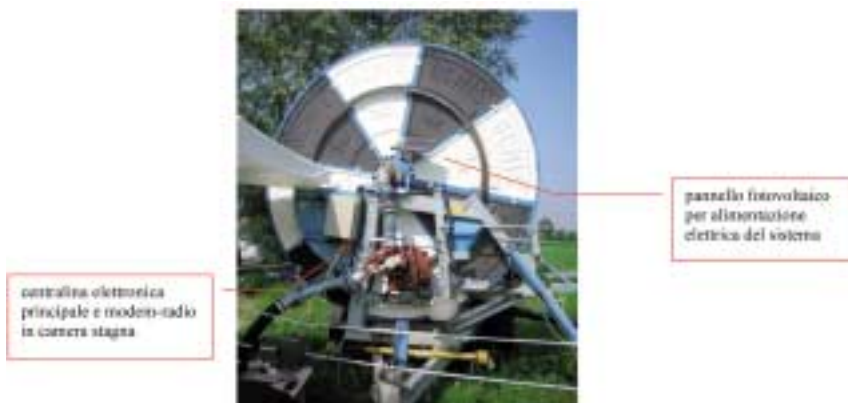
Fig. 3 – Dettaglio del rotolone con centralina elettronica principale di controllo. In color rosso mattone il sistema di trasmissione del moto rotatorio alla bobina che avvolge il tubo (Foto: Bisaglia).
