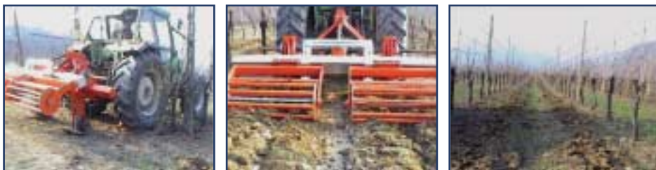
Figg. 8, 9 e 10 – Prove del ripper a 2 ancore in vigneto con terreno costipato dalle ruote del trattore: partenza dalla capezzagna; vista posteriore in fase di rippatura e frangitura delle zolle in terreno lavorato; risultato della lavorazione lungo un filare del vigneto inerbito.
