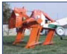
Fig. 5 e 6 – La macchina definitiva nelle versioni a doppia e tripla scarpa vibrante.
