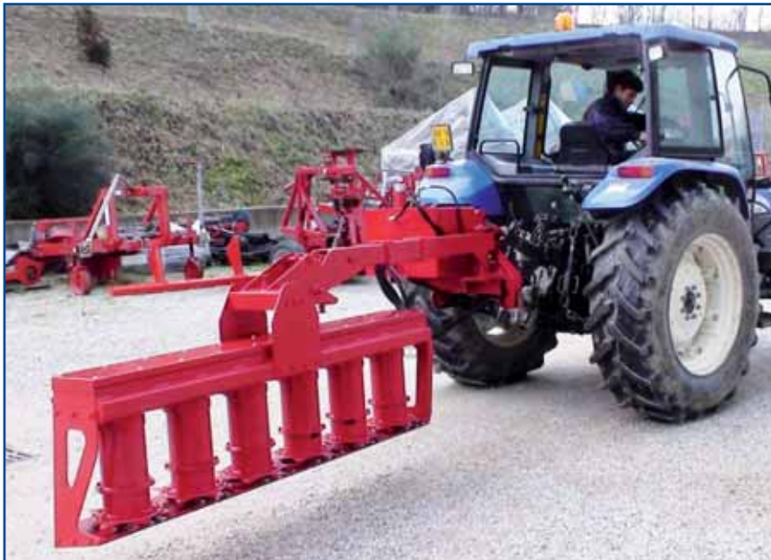
Foto 2 - Barra falciante ruotata di 90° per il trasporto su strada
