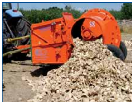
Fig. 9 - Pezzetti prodotti della macchina a 540 giri pdp e 15 cm/min di avanzamento
