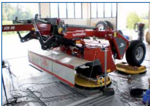
Fig. 5 - Banco vibrante a quattro attuatori configurato per la riproduzione di profili di terreno con falcia-condizionatrici trainate
