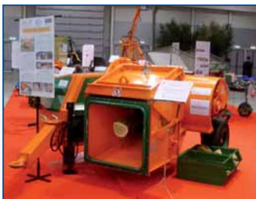
Fig. 7 - Vista frontale della macchina esposta all'AgriExpò di Roma; si nota il timone, la pdp, l'ingresso dei tronchi, l'uscita dei pezzetti, ecc.
