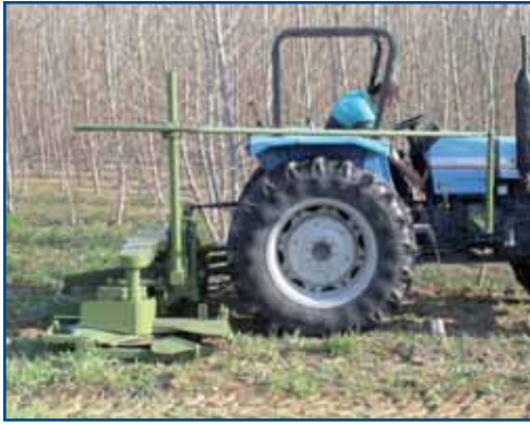
Fig. 3 - Abbattitrice realizzata dalla ditta ZPZ. Sono visibili il dispositivo di taglio e il profilato in metallo per agevolare la caduta delle piante sul terreno perpendicolarmente alla direzione di avanzamento del trattore
