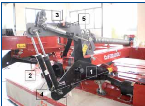
Fig. 2 - Sistema meccatronico di controllo semi-attivo della posizione della barra applicato sulla FC (1 = piastre di supporto; 2 = ammortizzatori a controllo elettronico; 3 = molla antidistacco; 4 = accelerometri (non visibili); 5 = centralina elettronica)
