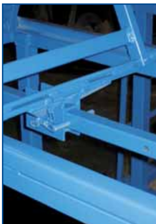
Fig. 3 - Sistema di bloccaggio del meccanismo a pantografo
