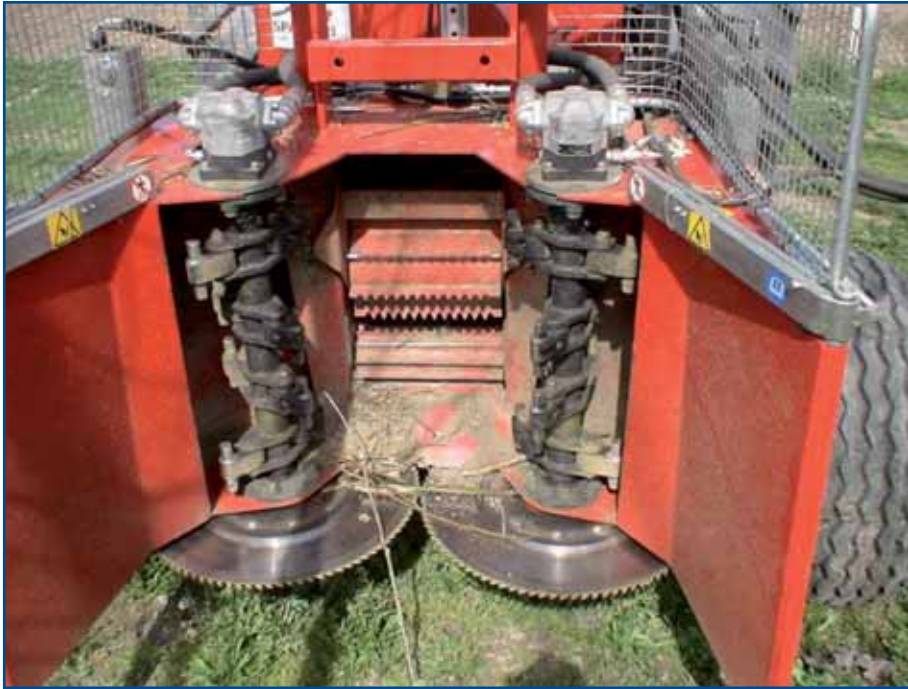
Foto 2 - Particolare della macchina e delle lame di taglio
