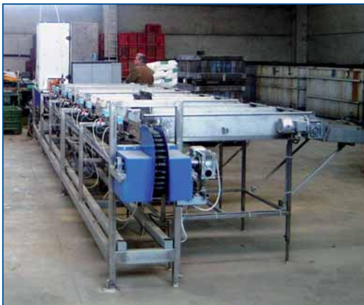
Foto 1 - Panoramica della macchina. In primo piano le vasche di raccolta delle talee in funzione della classe di diametro
