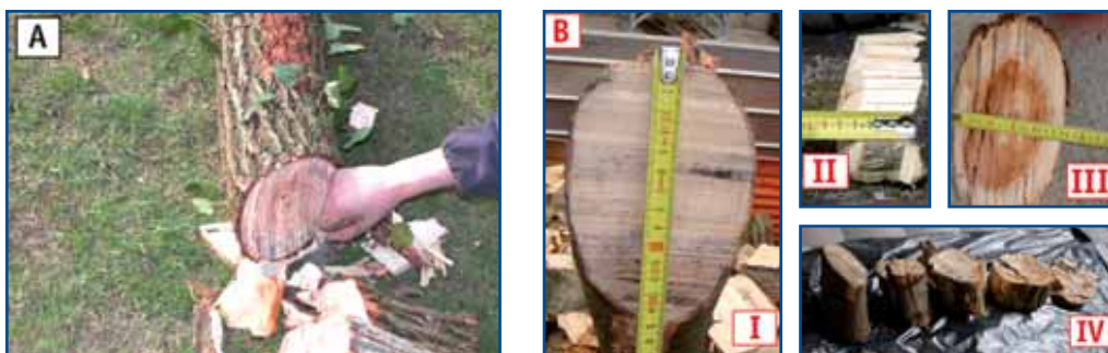
Fig. 10 - Esiti prove di taglio: A) tipico taglio di un tronco; B) dimensioni e forme dei pezzetti: I taglio netto a "fetta di salame" di corniolo, II e III vista laterale e frontale di pezzetti molto corti spaccati lungo la fibra dalla pressione della coclea, IV varie misure dei pezzetti prodotti
