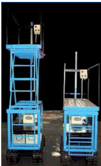
Fig. 5 - Piattaforma nelle due altezze estreme
