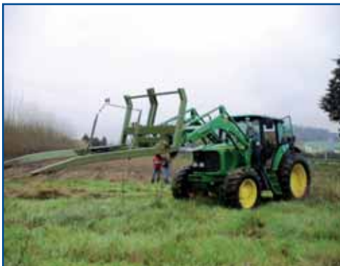
Fig. 5 - Macchina per la raccolta e l'accumulo delle piante abbattute a bordo campo della ditta ZPZ snc. È visibile il dispositivo idraulico per incrementare il carico della operatrice
