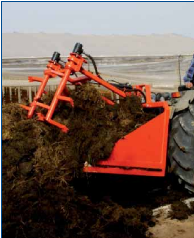
Fig. 3 - Spandicompost Sciacco s.r.l. - Prove di carico e distribuzione svolte con materiale organico
