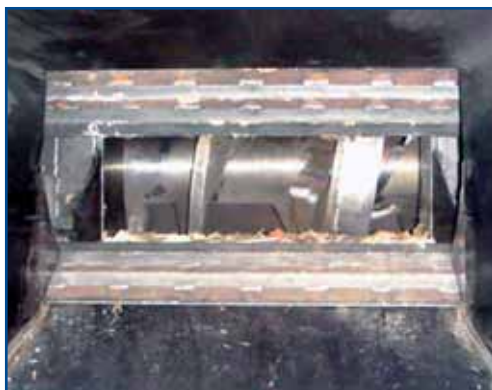
Fig. 5 - Rulli controrotanti divaricati per la spinta dei tronchi entro il sistema di taglio
