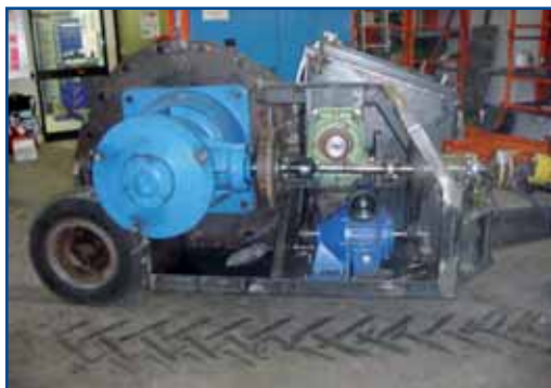
Fig. 3 - Pezzatrice dal lato del riduttore e dei dispositivi di rotazione dei rulli d'ingresso
