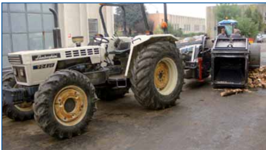
Fig. 6 - Vista generale del cantiere di lavoro del prototipo di macchina tronchettatrice collegata al trattore per utilizzarne la p.d.p.
