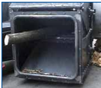
Fig. 4 - Tramoggia di ingresso dei tronchi dotata di due rulli rotanti per l'ingresso dei fusti
