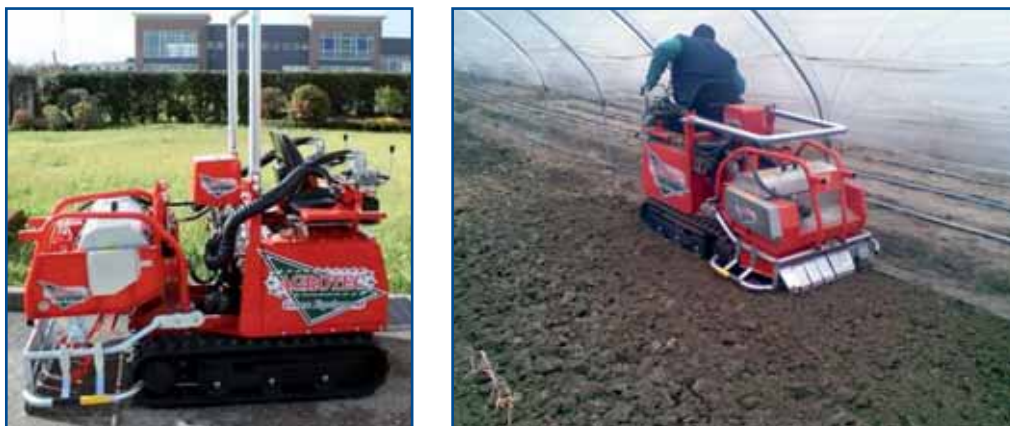
Fig. 2 - Il secondo prototipo della motovangatrice durante le prove in tunnel
