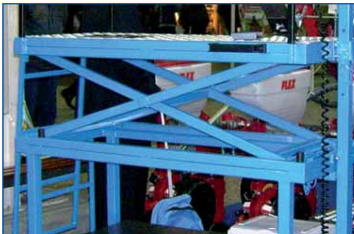
Fig. 2 - Meccanismo di sollevamento del pianale di lavoro
