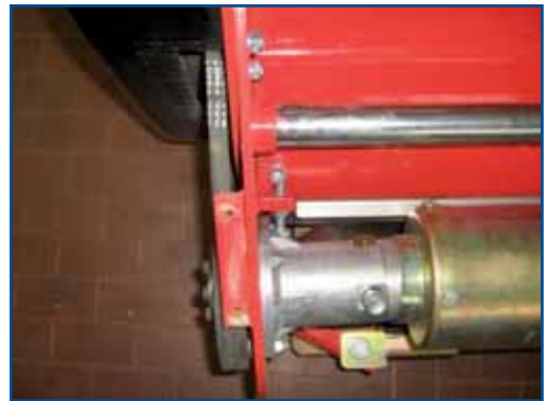
Fig. 4 - Componenti per la derivazione del moto dal sistema di trasmissione principale
