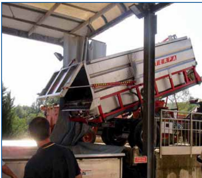
Fig. 2 - Prototipo con sistema di scarico per ribaltamento (carro B)
