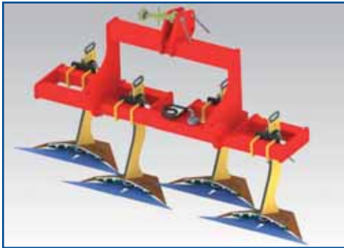
Fig. 3 - Fase Progettuale. Assemblaggio delle ancore sul telaio e di quest'ultimo sul Mix Tiller
