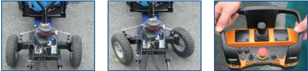
Fig. 1 - Dispositivi per il controllo remoto della sterzata e pannello di comando remoto
