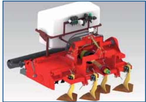
Fig. 3 - Fase Progettuale. Assemblaggio delle ancore sul telaio e di quest'ultimo sul Mix Tiller
