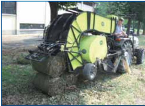
Fig. 3a - Lo scarico delle prime 3-4 rotoballe avviene grazie ad una paletta di spinta e all'avanzamento del trattore
