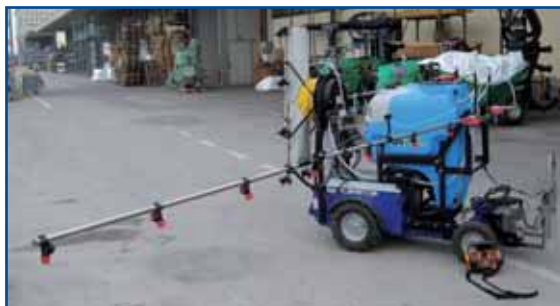
Fig. 6 - Versione aggiornata del sistema proposto con montata anche una barra di distribuzione orizzontale e Particolare del nuovo sistema di tastatori frontali
