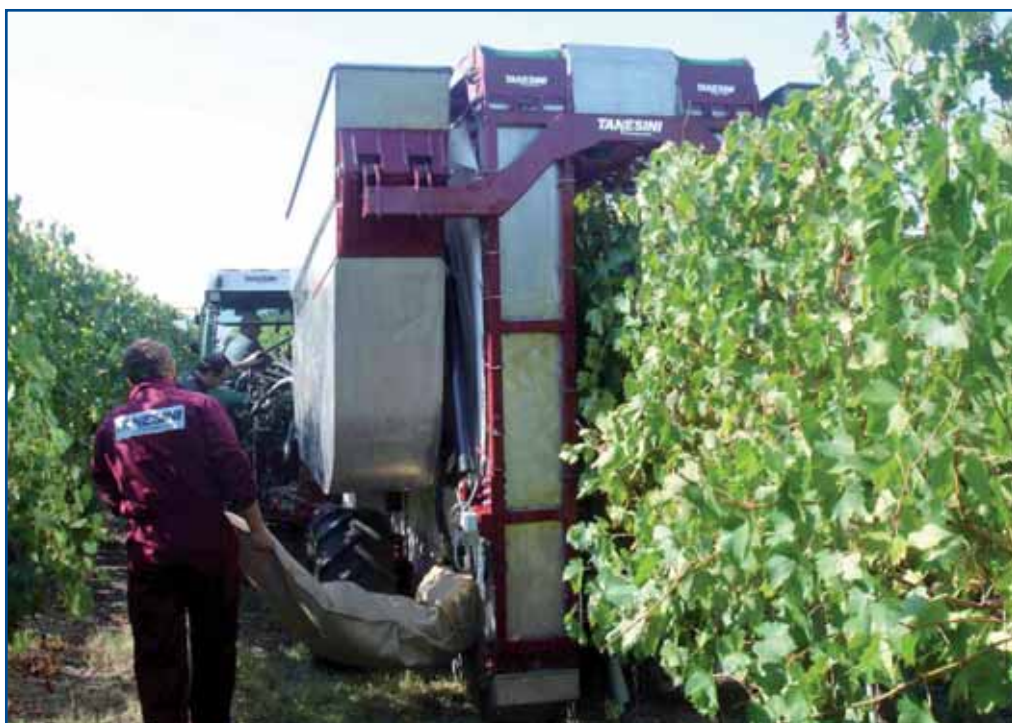
Fig. 3 - Rilievo delle perdite "occulte" allo scarico dei ventilatori utilizzati per l'eliminazione delle foglie distaccate
