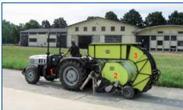
Fig. 2 - Il cantiere realizzato e utilizzato per le prove: (1) trattore specializzato da frutteto; (2) rotoimballatrice a camera di compressione fissa; (3) accumulatore di rotoballe
