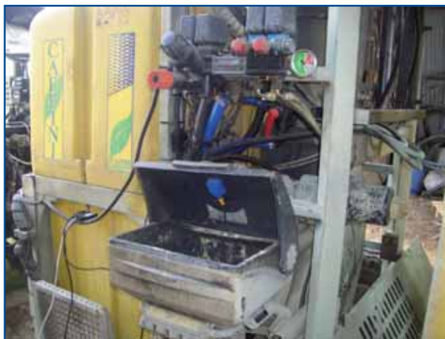
Fig. 2 - L'immagine mostra l'antenna di lettura installata nel premiscelatore
