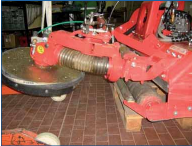
Fig. 3 - Particolare del dispositivo di taglio intercettibile adattabile alla posizione del terreno
