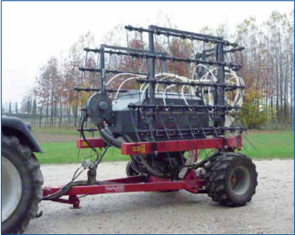
Fig. 1 - Il modulo di traino con il dosatore spargitore e l'erpice strigliatore
