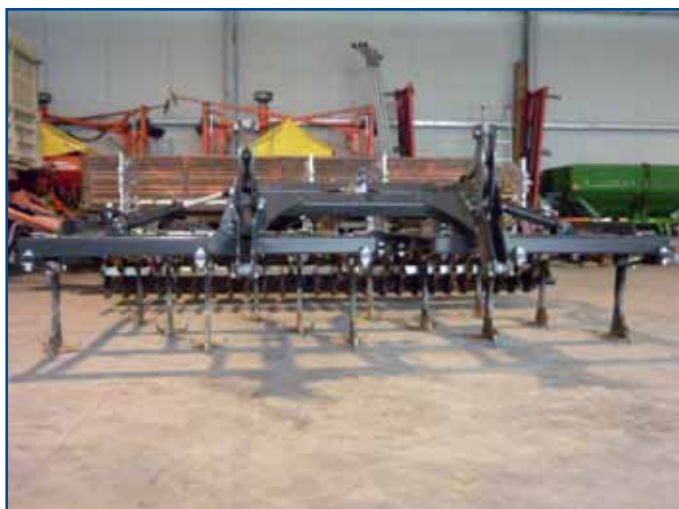
Fig. 3 - Il modulo erpice decompattatore
