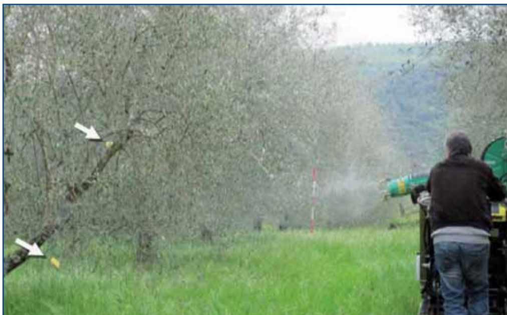
Fig. 1 - Determinazione della qualità del trattamento mediante cartine idrosensibili, evidenziate dalle frecce
