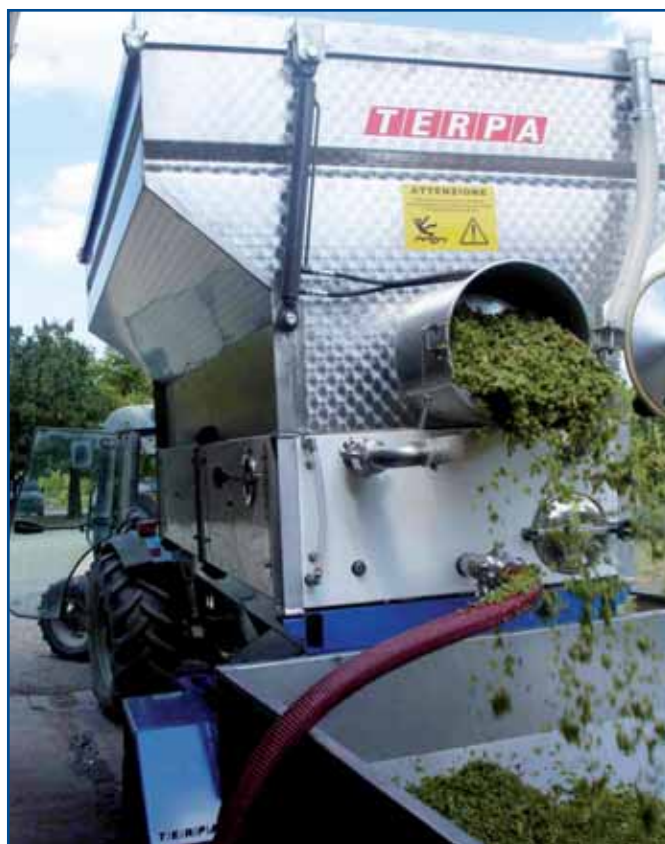
Fig. 3 - Scarico differenziato dell'uva sgrondata e del mosto separato
