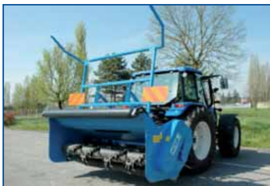
Fig. 1 - Secondo prototipo della macchina con particolare del rullo abbattitore
