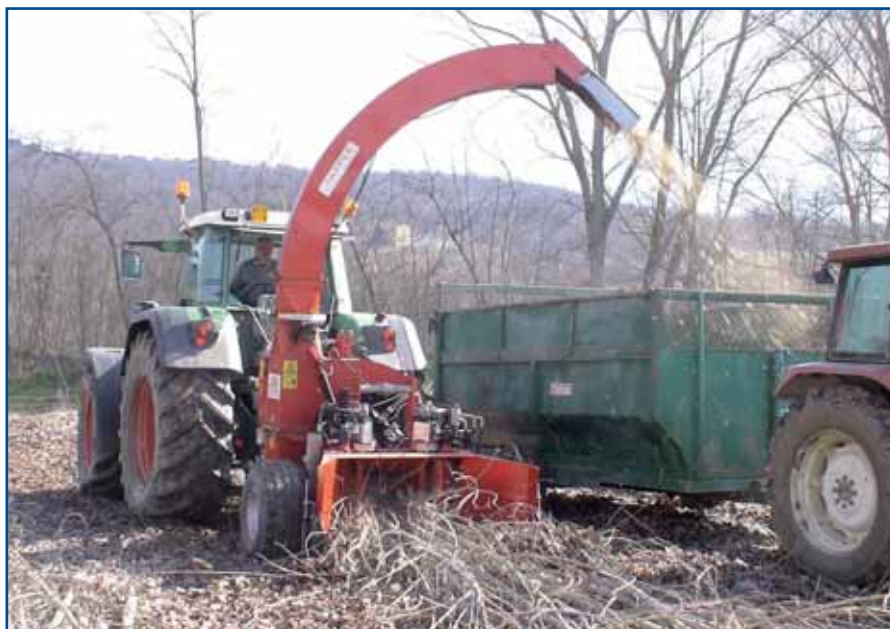
Foto 3 - Falciatrinciacaricatrice Spapperi mod. RT equipaggiata con testata pick up in raccolta delle andane
