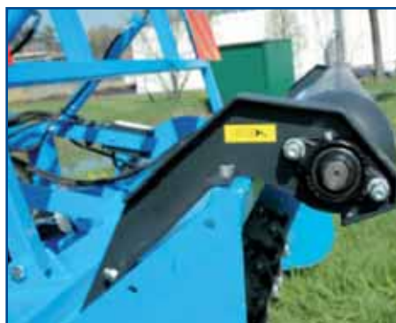
Fig. 1 - Secondo prototipo della macchina con particolare del rullo abbattitore
