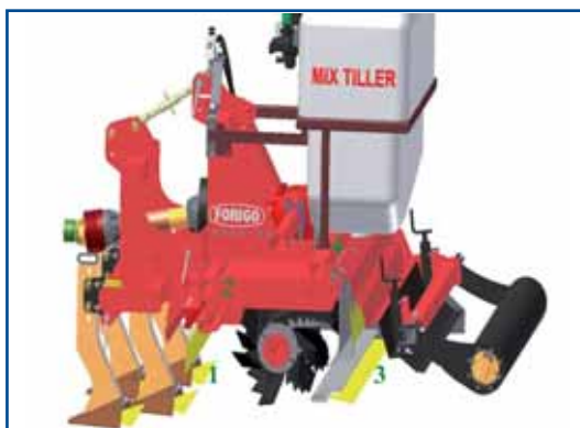
Fig. 4 - Prototipo - evidenziate: 1) le barre distributrici; 2) ancore; 3) barra anteriore; barra profonda; 4) barra posteriore superficiale
