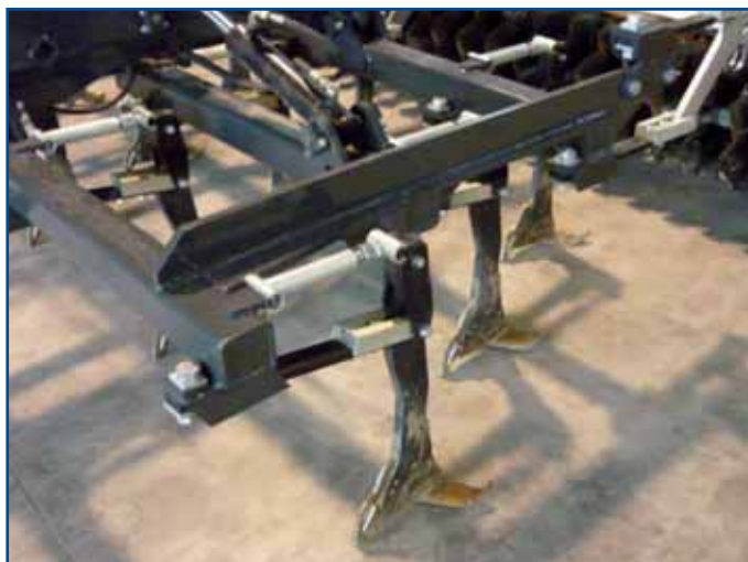
Fig 4 - Particolare delle ancore dell'erpice decompattatore e sistema di regolazione
