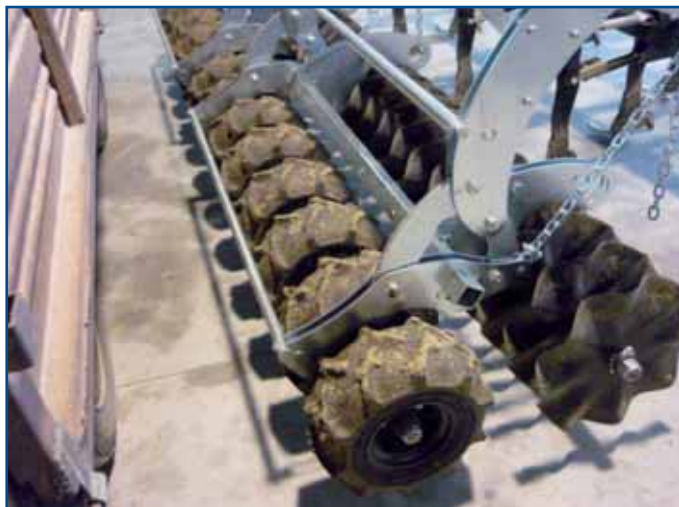
Fig. 5 - Il doppio rullo montato posteriormente all'erpice
