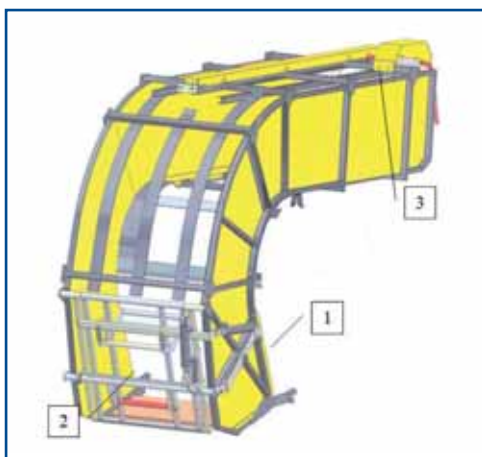
Fig. 1 - Schema dell'accumulatore realizzato: (1) ingresso dall'imballatrice; (2) portello di scarico con dispositivo di non ritorno; (3) paletta di scarico azionata da catena e pignoni
