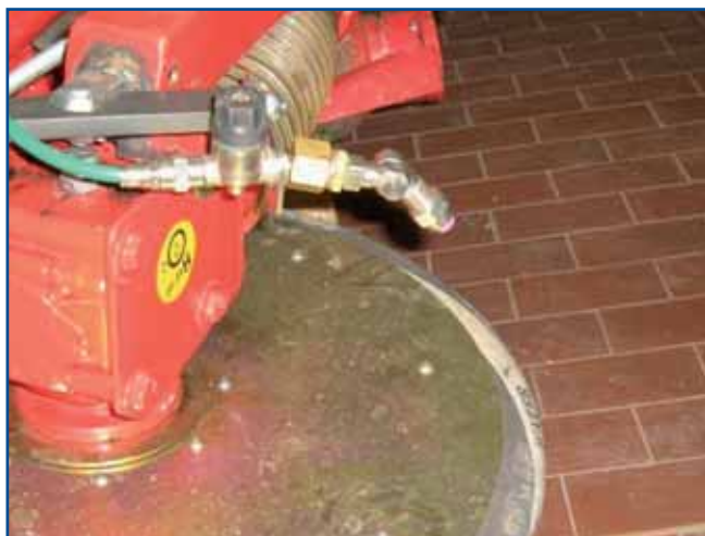
Fig. 5 - Ugello erogatore montato sul disco interceppi
