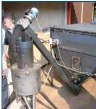
Fig. 3 - Alimentazione automatica della pellettatrice con cippato mediante trasportatore a coclea
