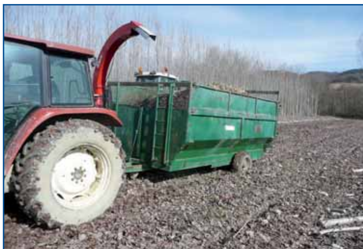
Foto 1 - Compattamento prodotto dal passaggio dei rimorchi carichi di cippato in condizioni di terreno con bassa portanza
