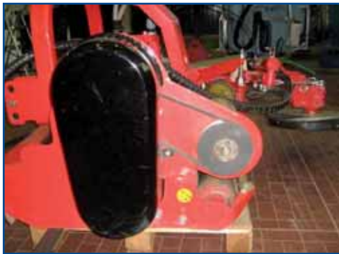
Fig. 4 - Componenti per la derivazione del moto dal sistema di trasmissione principale
