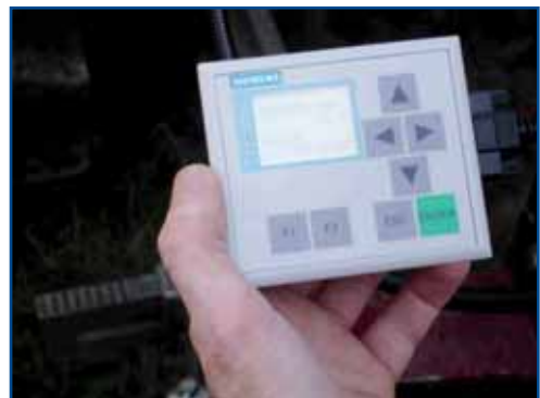
Fig. 2 - Sensore posizionato allo scarico degli aspiratori di foglie distaccate (sx) e display con tastiera posto sul quadro di comando della vendemmiatrice (dx)
