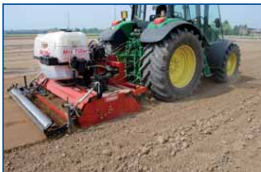
Fig. 5 - MT35-230 in prova con vista laterale sinistra: si notino le ancore, la ruota per rilevare la velocità ed il rullo dotato di moto proprio
