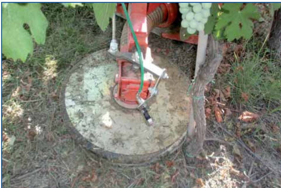
Fig. 9 - Particolare del disco interceppi e dell'ugello per il trattamento chimico
