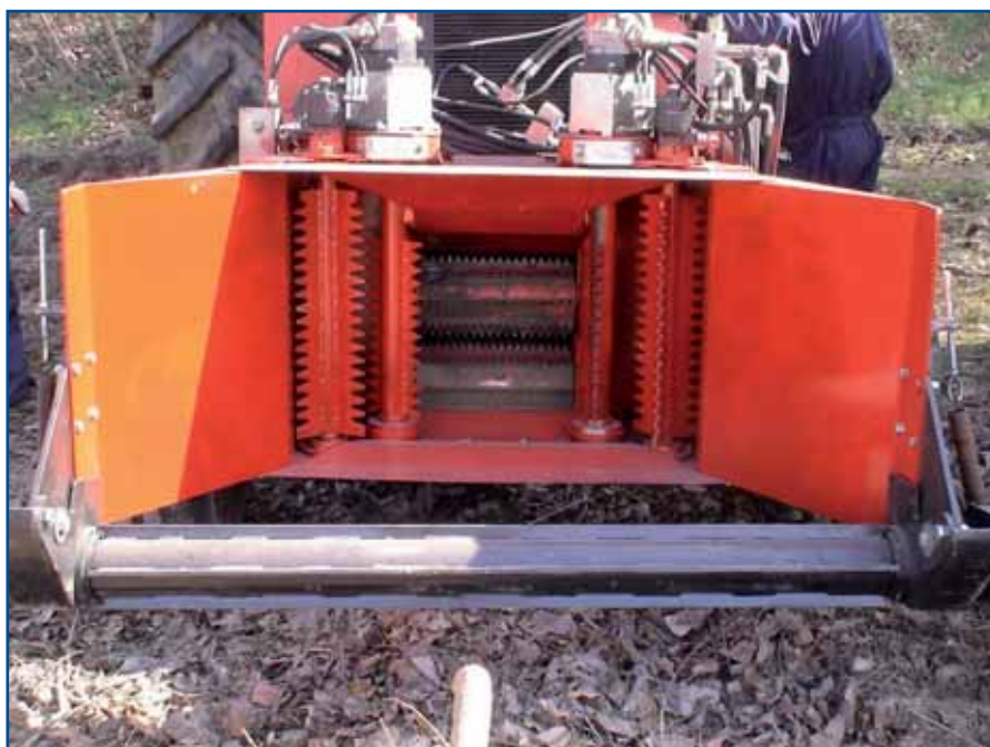
Foto 4 - Falciatrinciaticaricatrice Spapperi mod. RT equipaggiata con testata pick up: sono visibili il pick up rotativo per la raccolta delle piante andanate con i due dispositivi laterali per l'autolivellamento, i rulli verticali di convogliamento e i rulli ad asse orizzontale di alimentazione del cippatore
