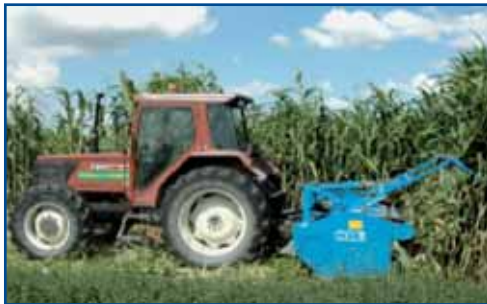
Fig. 6 - Prove di raccolta con il terzo prototipo, specifico per il sorgo da fibra ( Sorghum bicolor ), su colture erette e (a destra) allettate
