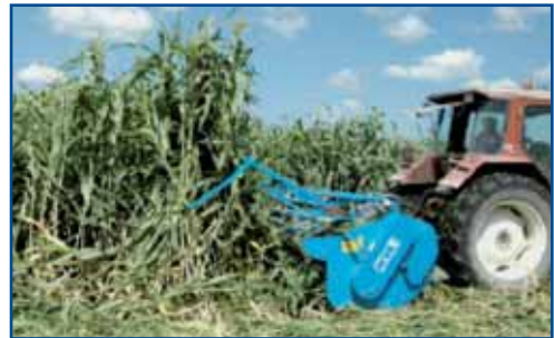
Fig. 6 - Prove di raccolta con il terzo prototipo, specifico per il sorgo da fibra ( Sorghum bicolor ), su colture erette e (a destra) allettate
