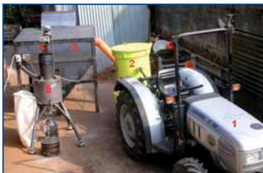
Fig. 1 - Un possibile lay-out del microimpianto realizzato per la produzione di pellet a livello aziendale (1 = trattore agricolo per l'azionamento del cippatore; 2 = cippatore a martelli a carica manuale; 3 = container di stoccaggio del cippato; 4 = coclea di alimentazione automatica della micropellettrice; 5 = micropellettrice)
