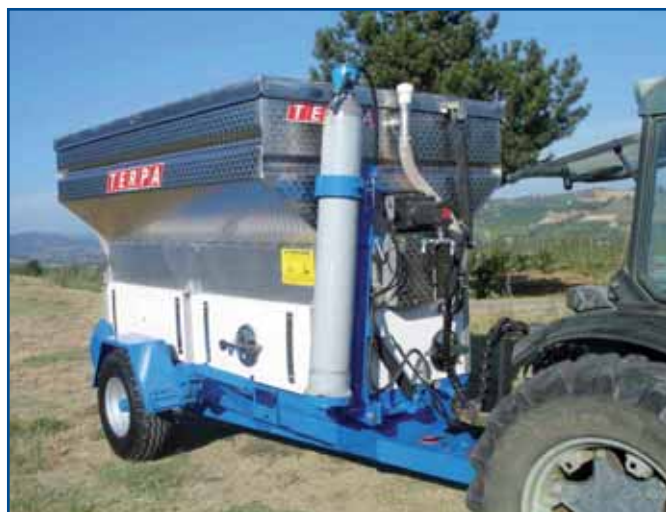
Fig. 1 - Prototipo con sistema di scarico a coclea (carro A). È visibile il serbatoio (bianco) per la raccolta del mosto libero e la bombola di \text{CO}_2 liquida utilizzata per l'inertizzazione
