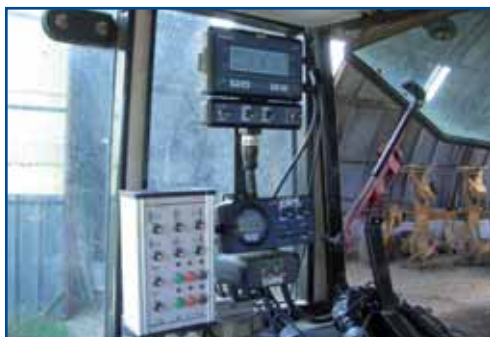
Fig. 3 - L'immagine mostra il computer "Bravo 300" installato nella cabina del trattore
