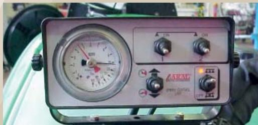
Esempio di comandi elettrici per l'immediata interruzione dell'irrorazione e per la variazione della pressione di esercizio posizionati in prossimità del posto di guida
