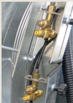
*Gruppi portaugello con dispositivi antigoccia in grado di evitare gocciolamenti una volta interrotta l'erogazione*
