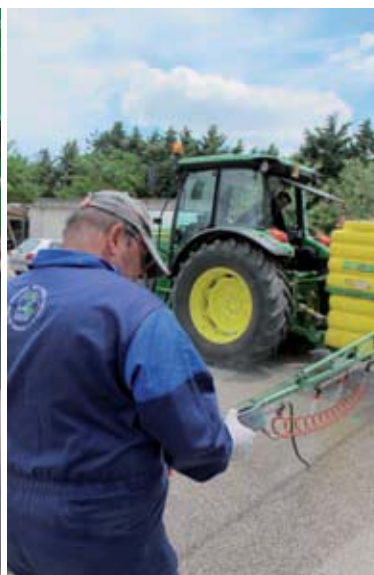
Verifiche dell'orizzontalità e simmetria della barra e dell'uniformità della portata degli ugelli: alcune fasi del controllo funzionale di una barra irroratrice.
