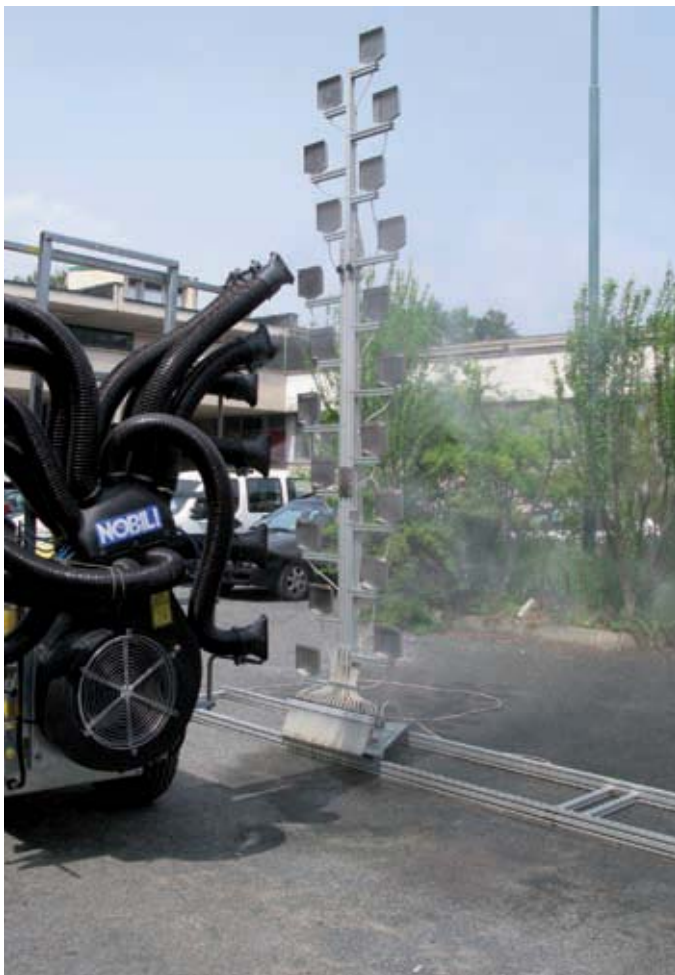
Determinazione del “diagramma di distribuzione” dell’irroratrice.
