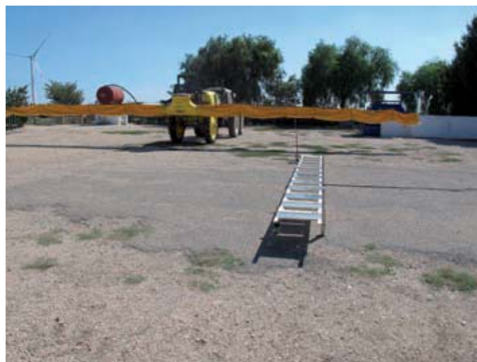
Controllo della deriva di una barra con manica ad aria.
