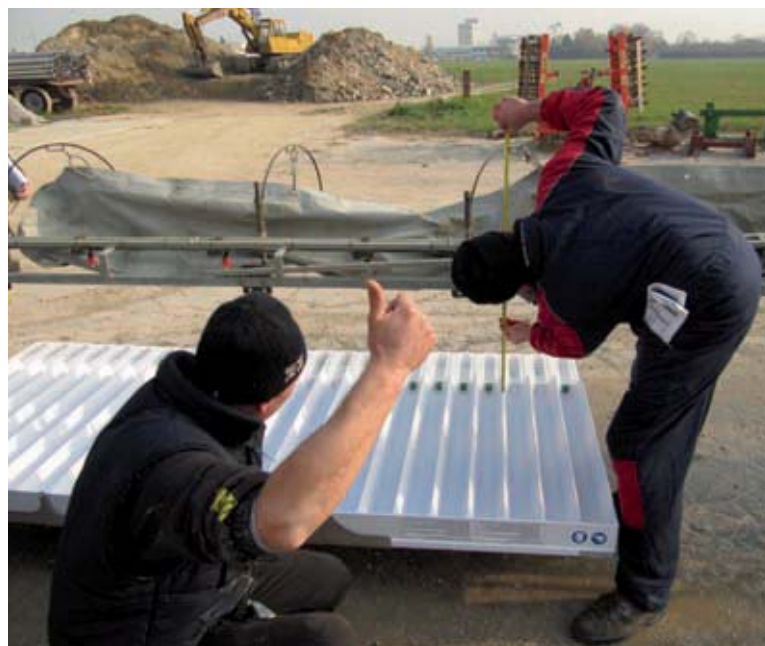
Posizionamento banco prova orizzontale, verifica altezza della barra.
