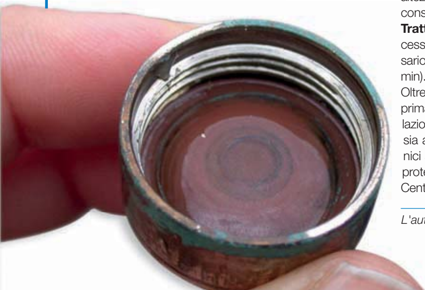
Ugello intasato da depositi.
