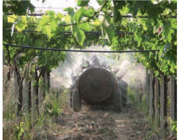
Atomizzatore al lavoro. Trattamento fitosanitario in un vigneto.
