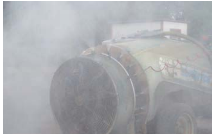
Verifica dell'efficienza di distribuzione di un atomizzatore durante un controllo funzionale.
