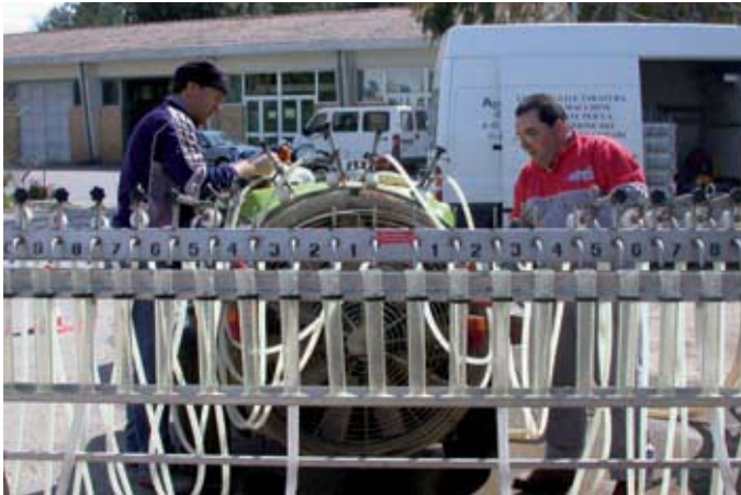
Verifica della portata dei diversi ugelli di un atomizzatore.
