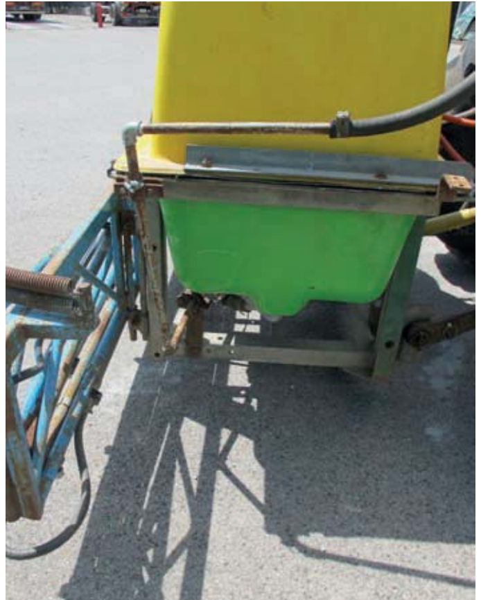
Riparazioni "artigianali" di tubazioni.
