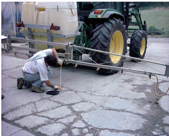
Fig. 11 – Verifica del corretto assetto della barra
