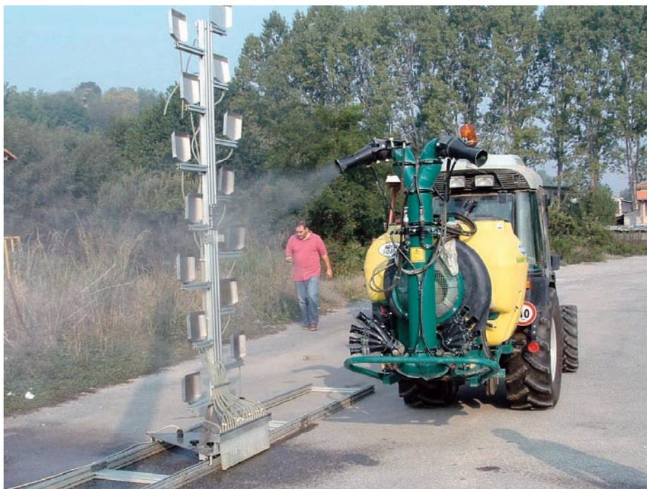
Fig. 16 – Determinazione del diagramma di distribuzione verticale (foto G. Oggero – DEIAFA)
