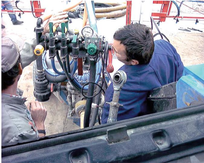
Fig. 13 – Verifica funzionalità del sistema di regolazione (foto G. Oggero – DEIAFA)
